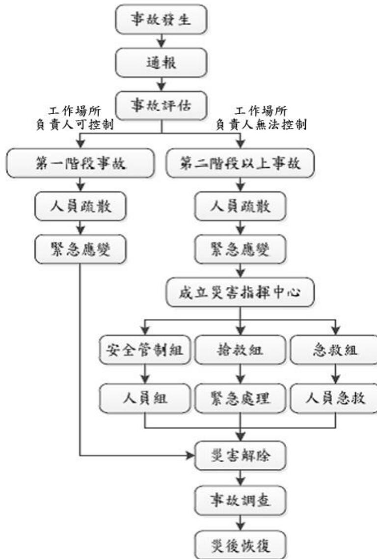
圖 1 緊急應變實施流程（一般流程）
